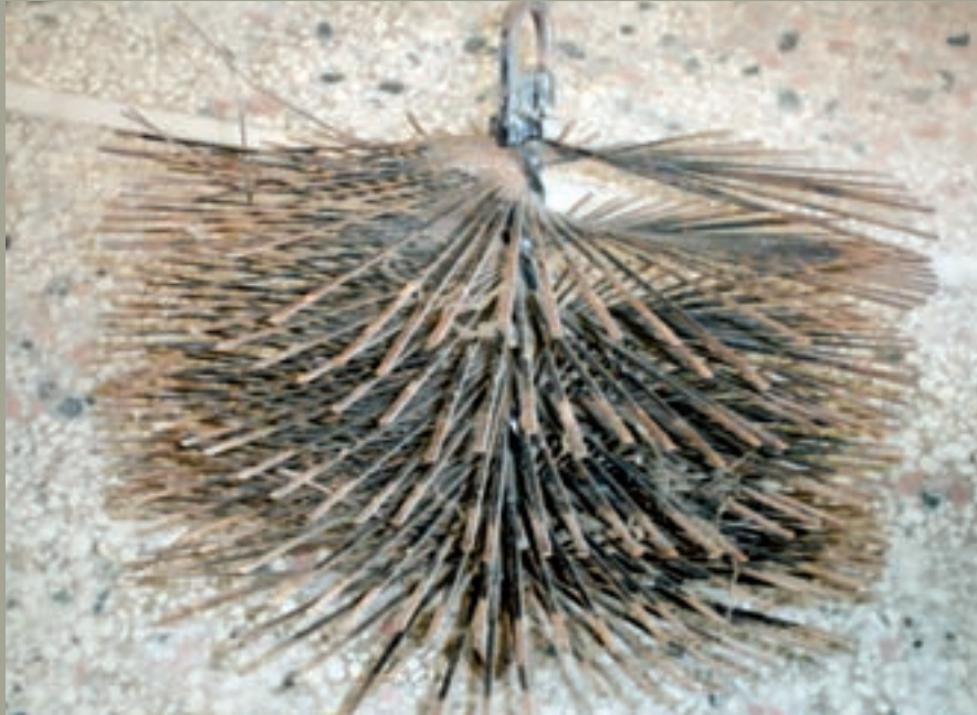
Εικ. 149: Μία άλλη όψη της βούρτσας, στην οποία φαίνονται τα σημεία πρόσδεσης στο συρματόσχοινο του τσικρικιού.
