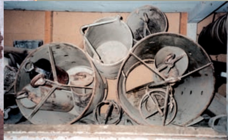
Εικ. 143: Οι κουβάδες με τους οποίους καθάριζαν κάποτε και με πολύ κόπο τους υπονόμους, ανήκουν πια στο παρελθόν. Η διάμετρος διαφέρει ώστε να ταιριάζουν στις διαφορετικές διατομές των υπονόμων. Διακρίνεται ο διαιρούμενος πάτος που διευκολύνει την επιστροφή.
