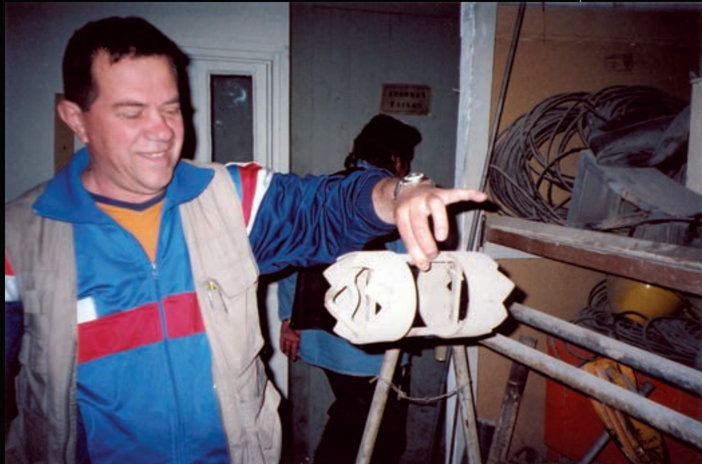
Εικ. 156: Ο Πάυλος Βασιλιάγκος, τεχνικός του Ο.Α.Θ. και της Ε.Υ.Α.Θ., κρατά έναν ριζοκόφτη που χρησιμοποιούνταν παλαιότερα.
