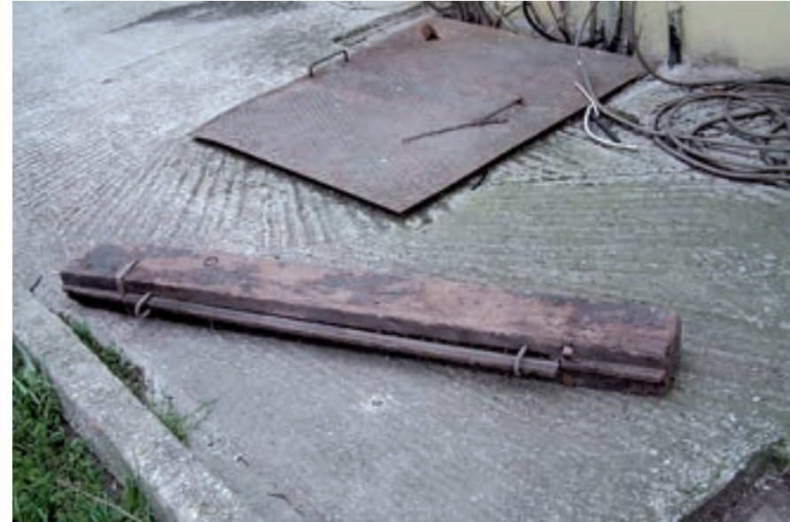
Εικ. 162: Δοκός που έφραζε τη ροή των λυμάτων (φωτογραφία: Α. Δεληγιάννης).
