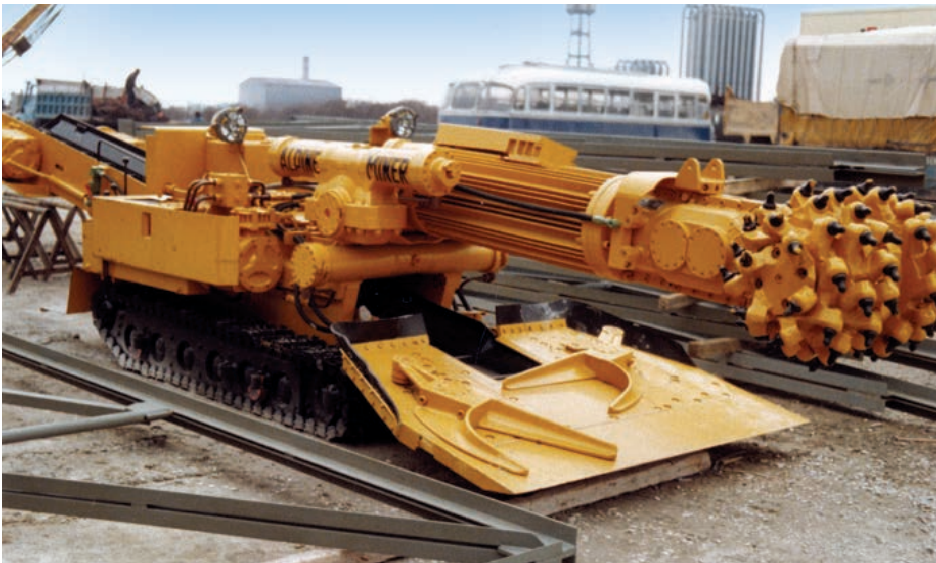
Εικ. 95: Το μηχάνημα εκσκαφής του Κ.Α.Α. Τα μαύρα στοιχεία στην κεφαλή του μηχανήματος κινούνται κυκλικά με την ενέργεια ηλεκτροκινητήρα και σκάβουν το έδαφος. Τα υλικά εκσκαφής συγκεντρώνονται στο κάτω μεγάλο κίτρινο φτυάρι του μηχανήματος και στη συνέχεια, με τους κινούμενους βραχίονες, σε μεταφορική ταινία που κινείται κάτω, στη μέση του μηχανήματος (στη διπλανή φωτογραφία) και τελικά σε βαγονέτα για την απομάκρυνσή τους από τη σήραγγα.
