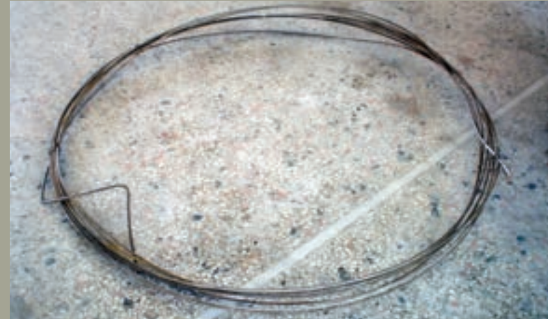
Εικ. 148: Η ασαλίνα που χρησιμοποιείται για να περάσει η αλυσίδα ή το συρματόσχοινο του τσικρικιού στο απέναντι φρεάτιο.
