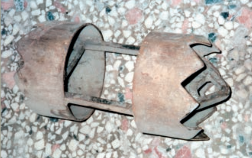
Εικ. 145: Ριζοκόφτης που δενόταν στο συρματόσχοινο του τσικρικιού.
