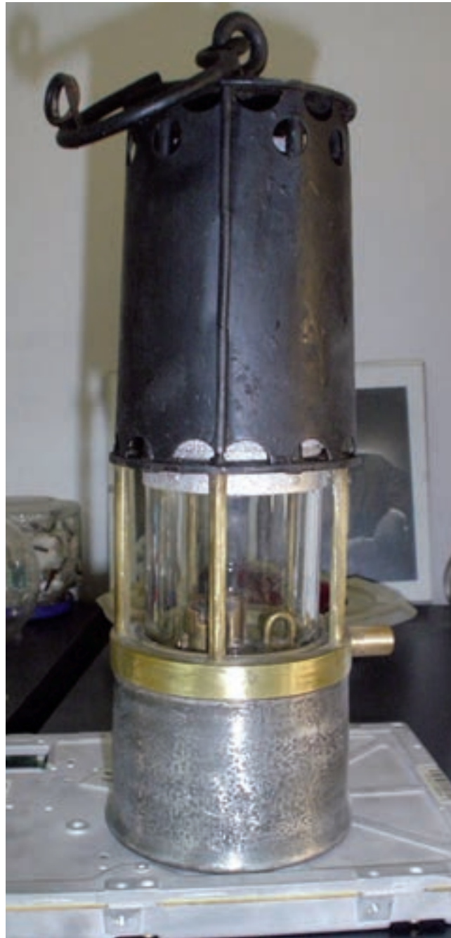
Εικ. 161: Προειδοποιητικός φανός ορυχείων που χρησιμοποιούνταν από το προσωπικό που επισκεπτόταν τους υπονόμους.
