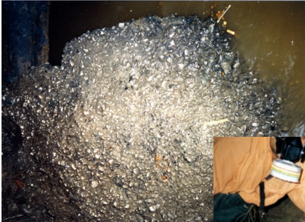
Εικ. 77: Το πάπλωμα (σκληρυνθέν λίπος) (φωτογραφία: Χρ. Τραγανός).
