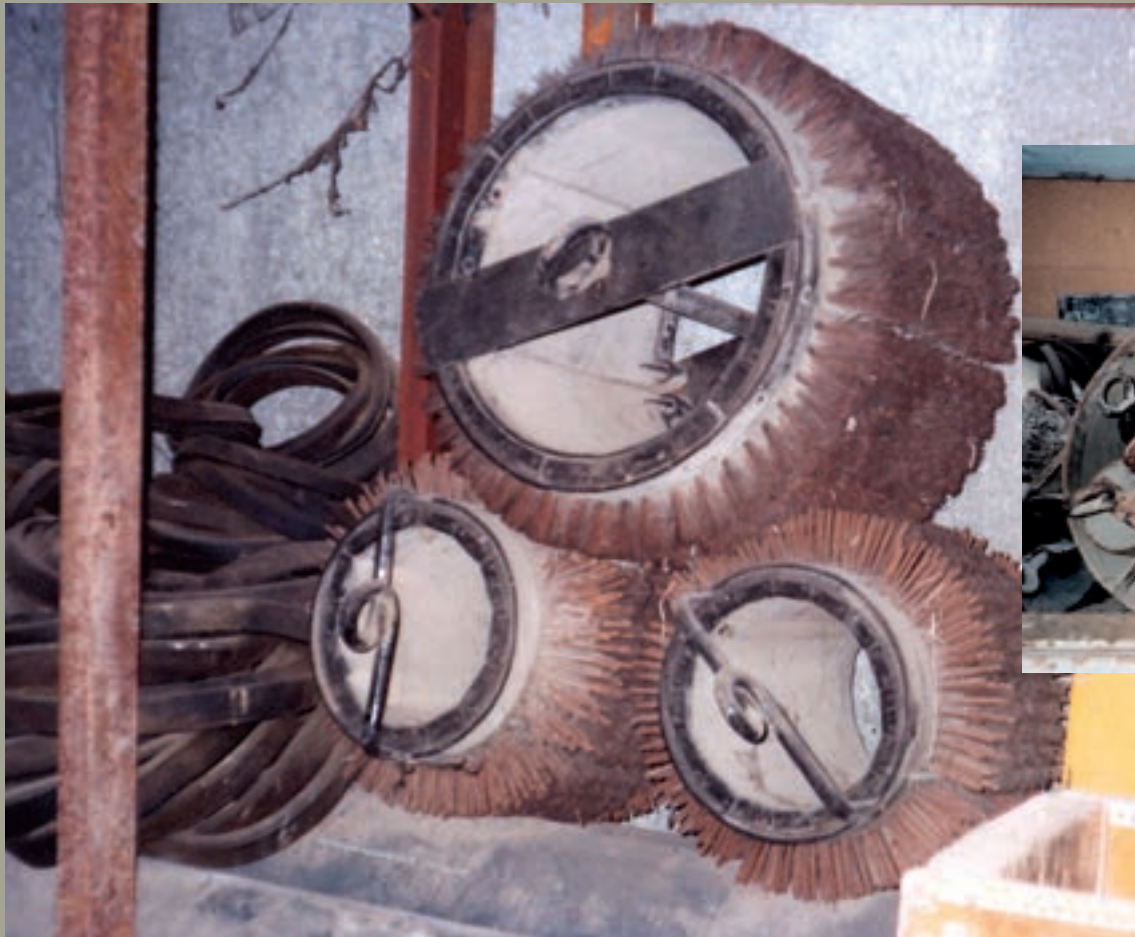
Εικ. 142: Βούρτσες διαφόρων διαμέτρων που προσαρμόζονται στο συρματόσχοινο του σικκριού (βαρούλκου) για τον καθαρισμό των υπονόμων.
