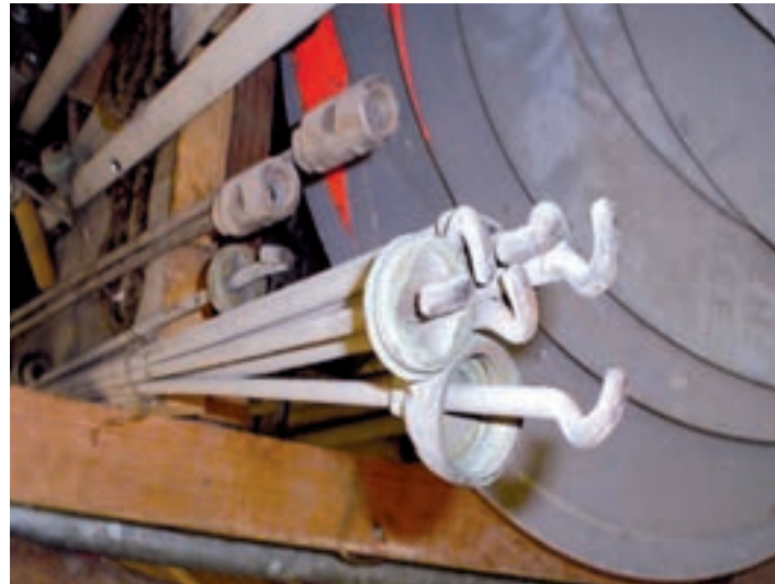
Εικ. 154: Σίδερα και καλάμια μήκους δύο μέτρων, στα οποία προσαρμόζονταν καθρέπτες, ελατήρια ή βούρτσες για τον καθαρισμό των υπονόμων.
