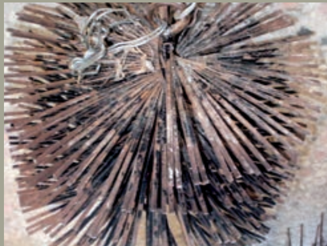
Εικ. 149: Μία άλλη όψη της βούρτσας, στην οποία φαίνονται τα σημεία πρόσδεσης στο συρματόσχοινο του τσικρικιού.
